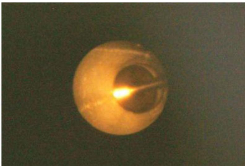
Nach etwa einer Stunde Leerlaufbetrieb haben sich nahezu alle Verkokungen aufgelöst, das Ventil ist metallisch blank, die Ansaugwege im Zylinderkopf ebenso.
